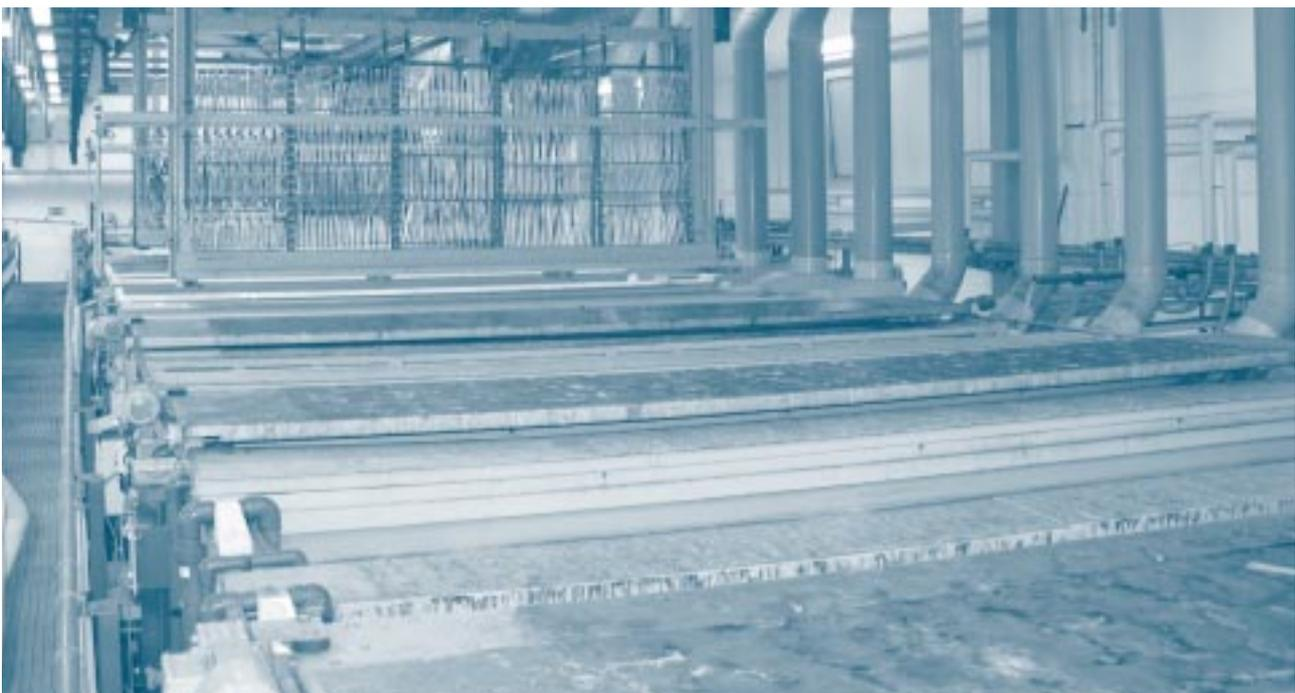
dass sich eine Aufkonzentrierung (durch Verdunstung, Verdampfung) und Rückführung ins Prozessbad lohnt. Dabei muss darauf geachtet werden, dass Störstoffe vor der Rückführung entfernt werden. In der Praxis werden meist 3-stufige Kaskaden eingesetzt. Das Frischwasser wird dabei in der letzten Spülstufe aufgegeben und im Gegenstrom – entgegen dem Teiledurchsatz – stufenweise aufkonzentriert.
